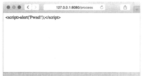
图 5-10 多谢 Go 的模板引擎，原本会导致漏洞的用户输入已经被转义了
